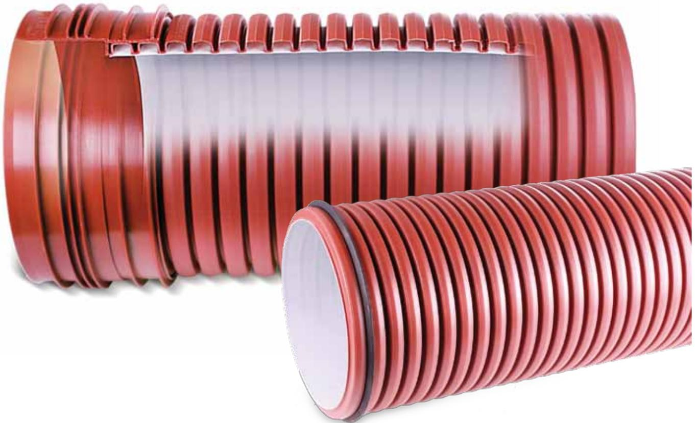
**Pragma®** и **Pragma® PRO16** – раструбная труба с двойной структурированной стенкой, предназначенная для строительства безнапорных систем водоотведения. Трубы производятся из полипропилена-блоксополимера. Метод производства, двойная соэкструзия, когда одновременно изготавливаются внутренняя и наружная стенки, образующие на выходе из экструдера единое целое.
