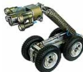
**При обслуживании системы колодцев Pragma® с помощью телеинспекции и гидромашин нет необходимости в нахождении человека внутри колодца, т.к. все операции проводятся с поверхности земли.**
