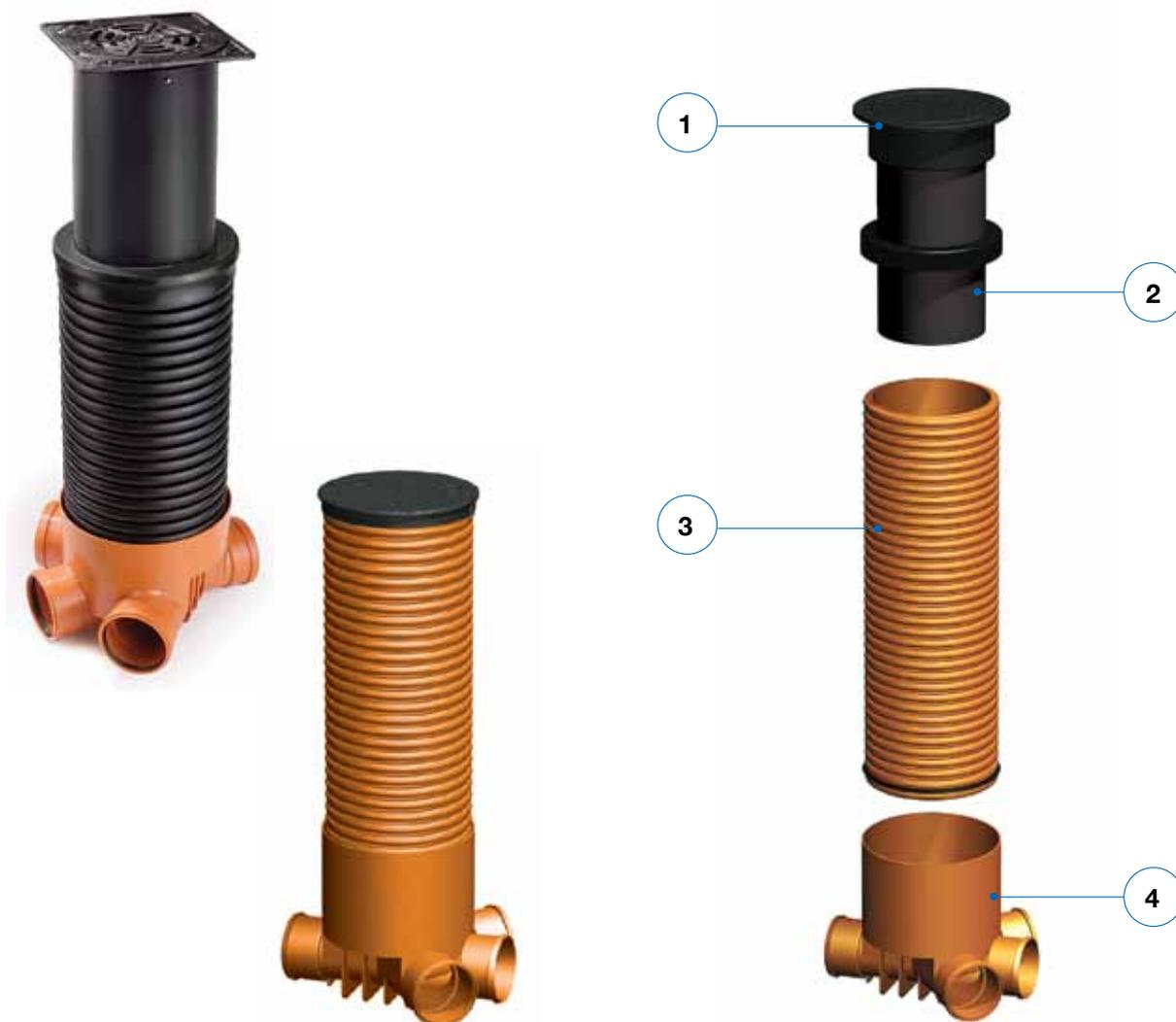
**Колодец КК 400** – предназначен для использования на мест DN 110 – 400 мм. Верхняя часть колодца представляет из себя телескоп-трубу DN 315 мм с чугунной рамой и люком класса нагрузки B125 или D400.
